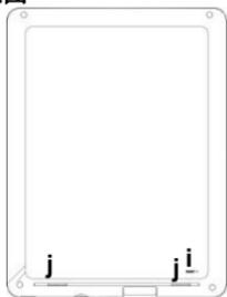
i. 复位孔 - 机器无响应时，按此键重启机器。
